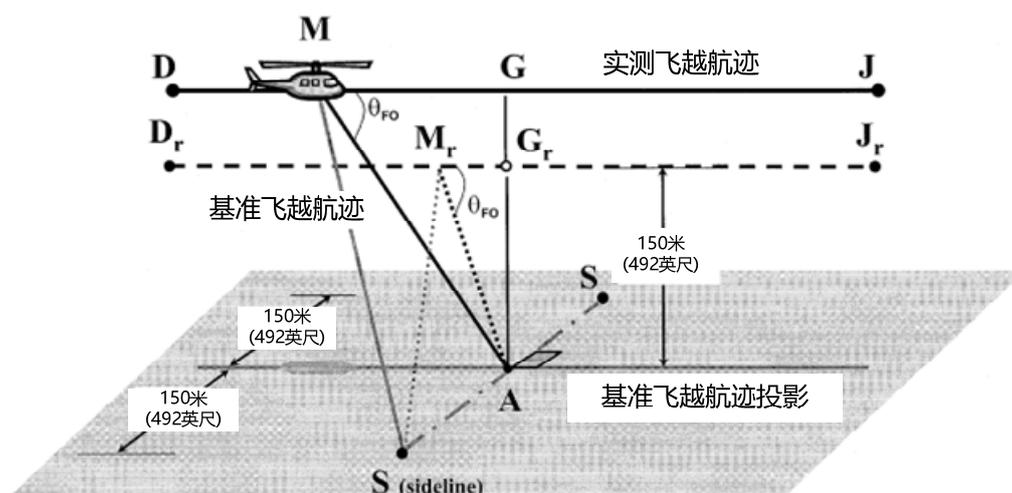
图 H2 实测和基准飞越剖面的比较
