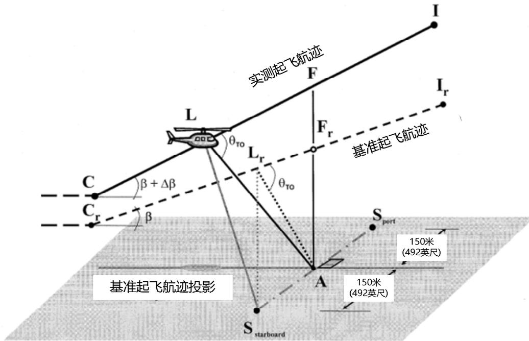
图 H1 实测和基准起飞剖面的比较
