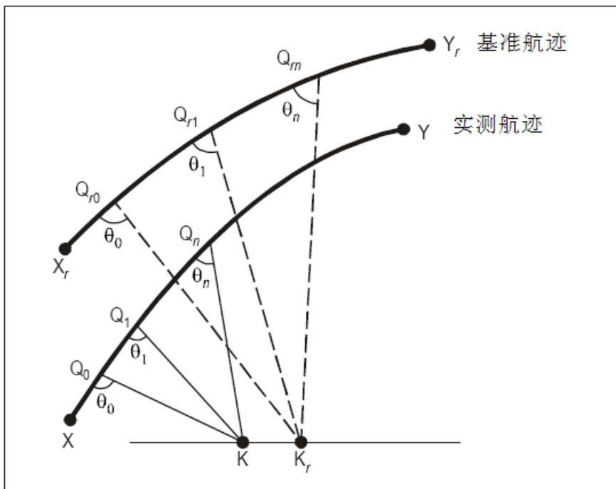
图 A36-10 完整的修正方法中实测与基准航迹的对应
