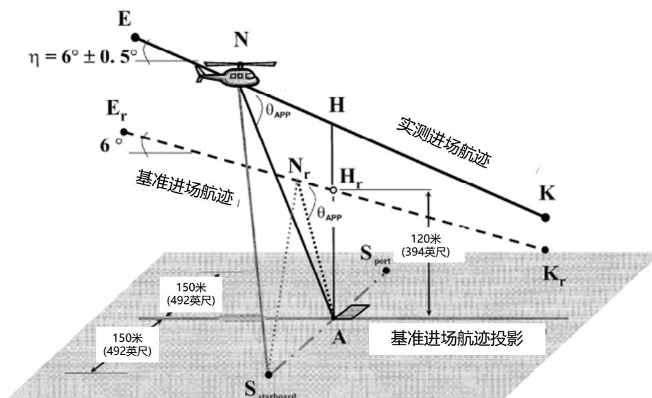
图 H3 实测和基准进近剖面的比较
