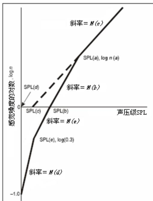
图 A36-3 作为声压级函数的感觉噪度
