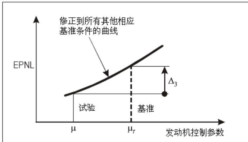
图 A36-8 噪声推力修正
