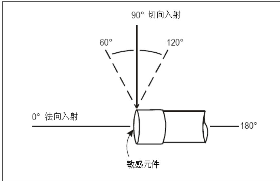
图 A36-1 传声器的声入射角示意图
