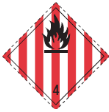
(No.4.1) 第 4.1 类 易燃固体 符号(火焰): 黑色。 底色: 白色加上七条 垂直红色条带。 数字'4'写在底角。
