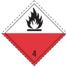
(No.4.2) 第 4.2 类 易自燃物质 符号(火焰): 黑色。 底色: 上半部为白色, 下半部为红色。 数字'4'写在底角。
