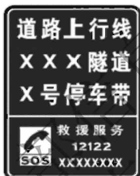
Figure A.0.7 Schéma du Panneau de la Bande d'Arrêt d'Urgence
