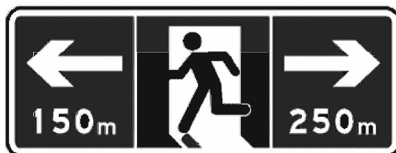
Figure A.0.5 Schéma du panneau d'Indication d'Évacuation
