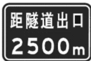
Figure A.0.6 Schéma du panneaux d'indication de distance à la sortie du tunnel
