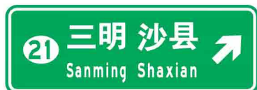
图 6.7.5 位于隧道内的出口预告标志示例
