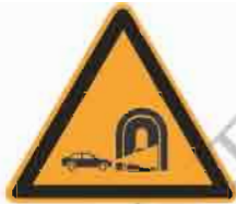
图 B.4.2-2 隧道开车灯标志
