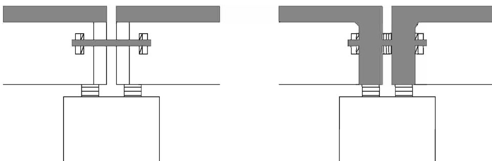
图 15.6.1-3 桥墩处拉杆式防落梁构造
