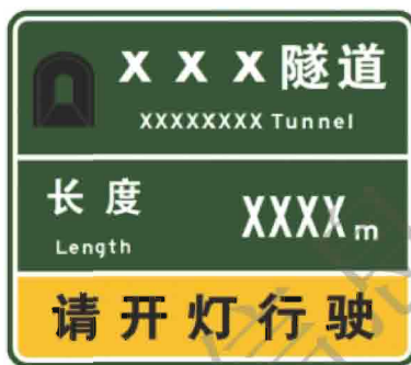
图 A.0.1 隧道信息标志版面示意图
