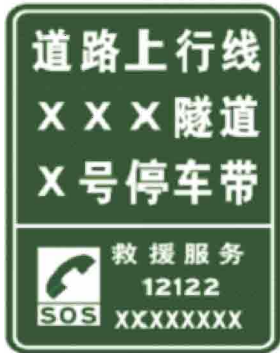
图 A.0.7 紧急停车带位置提示标志版面示意图
