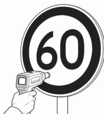
图 T 9018-1 逆反射系数测试示意图
