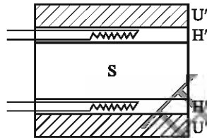
图 T 1116-2 单试件热流计对称布置
