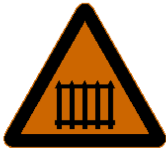
图 155 警 26 有人看守铁路道口
