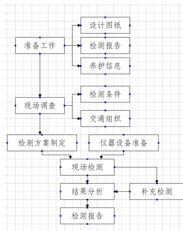
图 3.1.1 公路桥梁现场检测基本程序图
