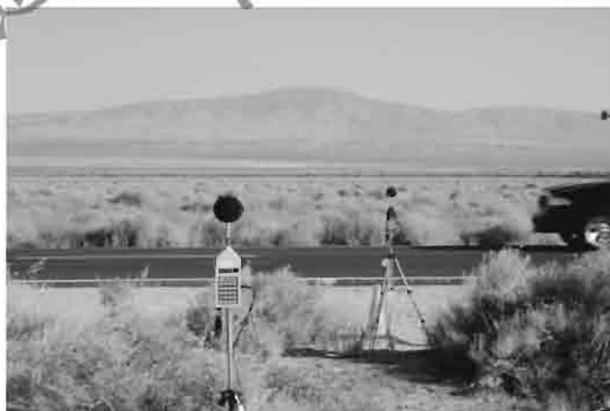
图 T 0986-3 远场法交通噪声测试
