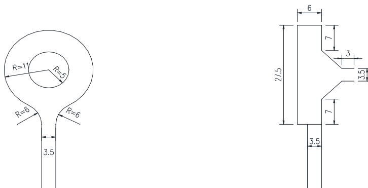
图 13-3 掉头场地参考示例（尺寸单位：m）
