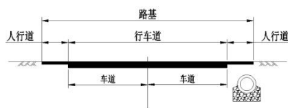
图 A-3 四级公路（I类）村镇段标准断面图
