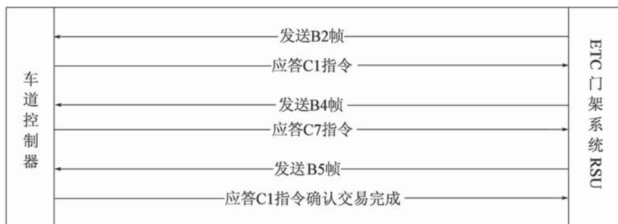
图 E.5.5-3 MTC 车辆交易流程
