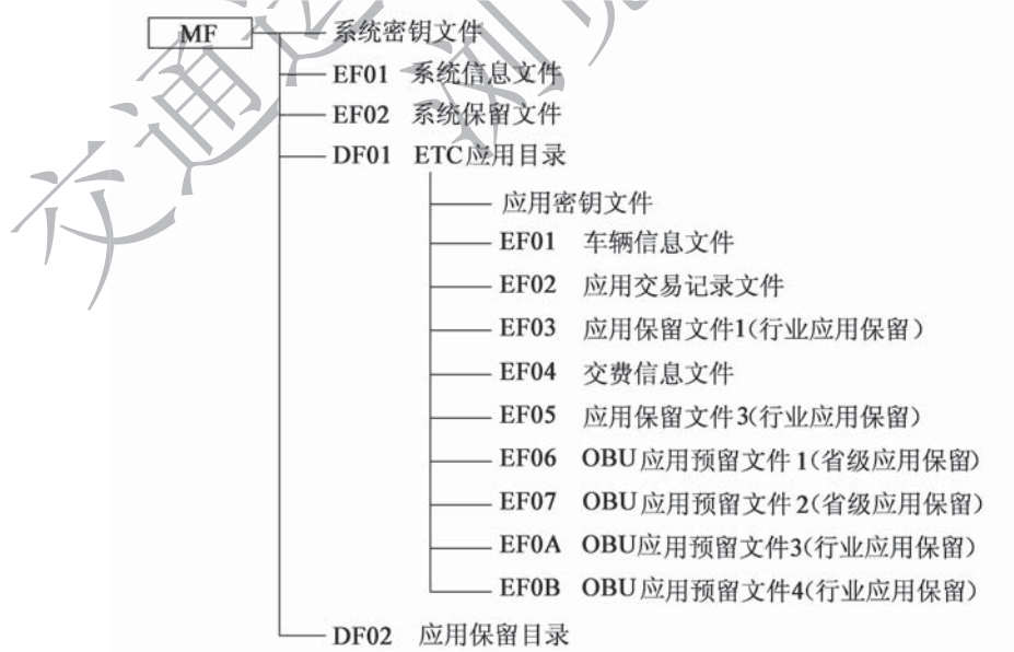
图 M. 3. 3 国际算法双片式 OBE-SAM 文件结构图
