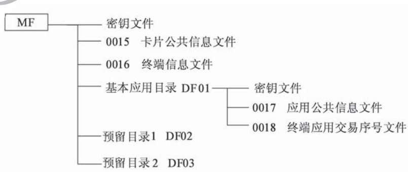
图 N.1.2 PSAM/PCI 密码卡的文件结构图
