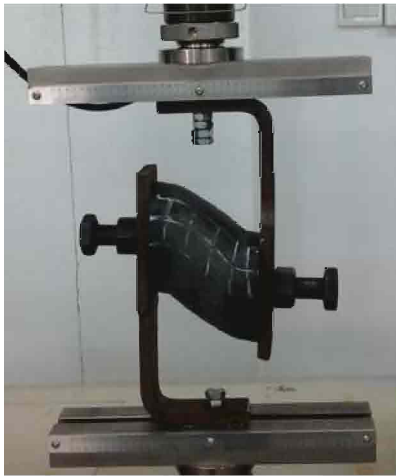
图G.3.2-2 剪切位移弹簧力学性能单剪试验试件工装布置图
