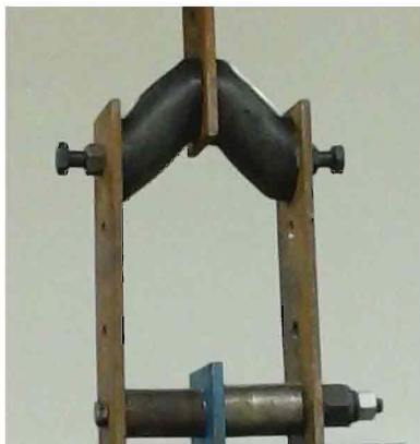
图G.3.2-1 剪切位移弹簧力学性能双剪试验试件工装布置图
