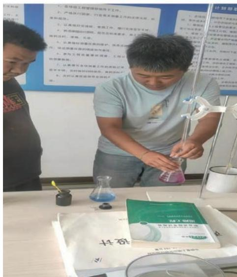
图9 EDTA 测定水泥剂量
