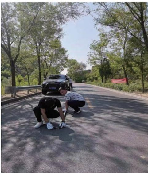
图8 检测路面平整度
