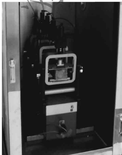
图 T 0865-3 无机结合料稳定材料疲劳试验(B法)
