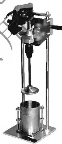
图 T 1221-5 振动锤压实试验机
