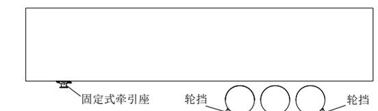
图2 半挂车纵向栓固轮挡布置示意图
