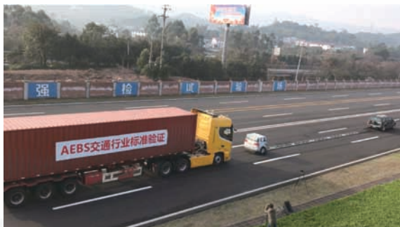
图23 营运车辆自动紧急制动系统 工况验证试验实车测试
