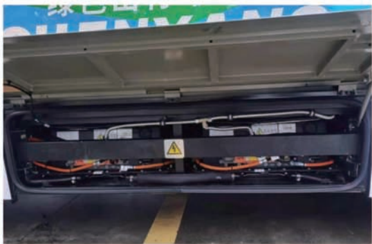
图 20 电动公共汽车电池舱
