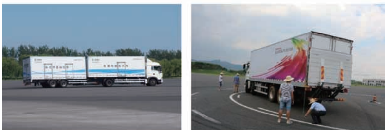
图 11 营运货车稳态回转试验和通道圆试验
