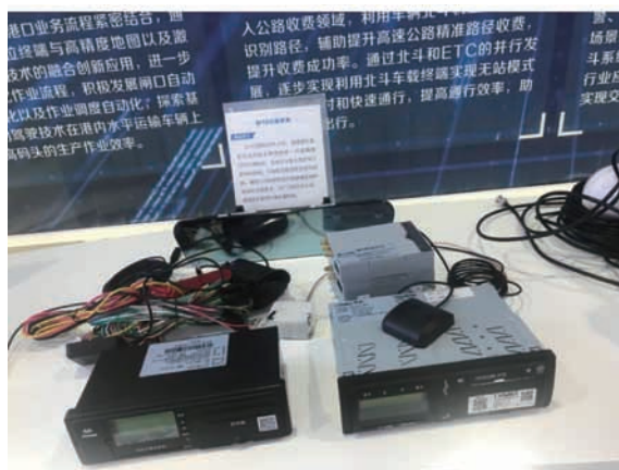
图24 道路运输车辆卫星定位系统 高精度车载定位终端
