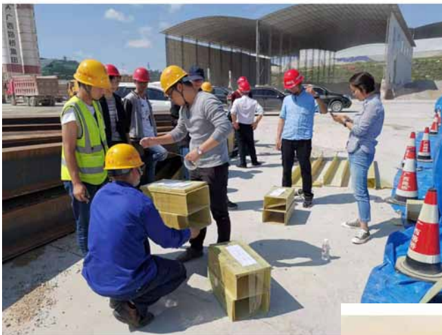
图 28 玻璃钢管箱产品 现场抽样
