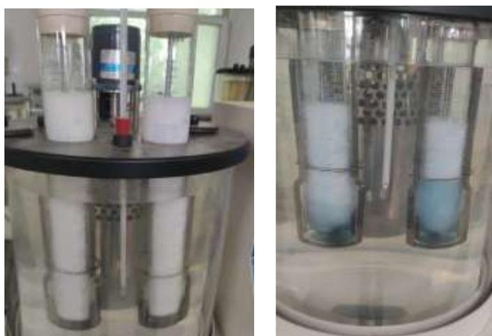
图 7 冷却液常温下泡沫倾向
