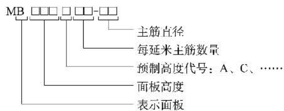
图 E.0.2 预制面板型号标记图示
