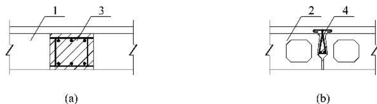
图 6.3.6 预制面板之间接缝连接
